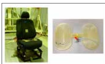
自動車用シート振動制御装置の開発
